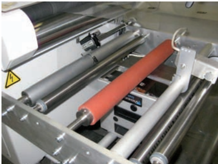
Encoder für Dataflex 53 mm Videojet printer
